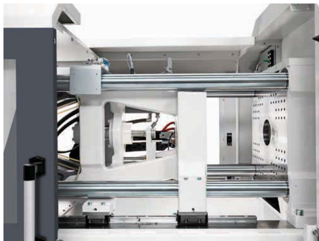
» Slika 2: Zapiralna enota serije PX s 5-točkovnim kolenskim sistemom zapiranja je hitra, natančna ter vzdržljiva
